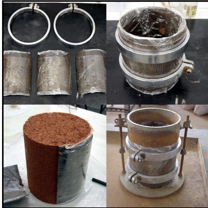
Figura..3.23: Montagem tri-partido – tamanho CBR
