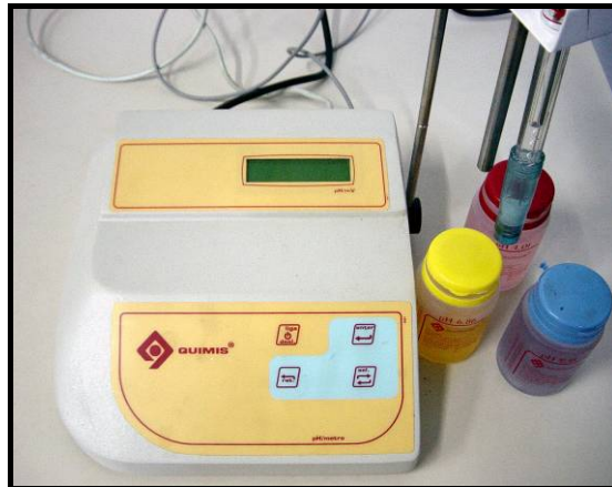
Figura 3.11: pHmetro Quimis utilizado na determinação do potencial hidrogeniônico (pH)
