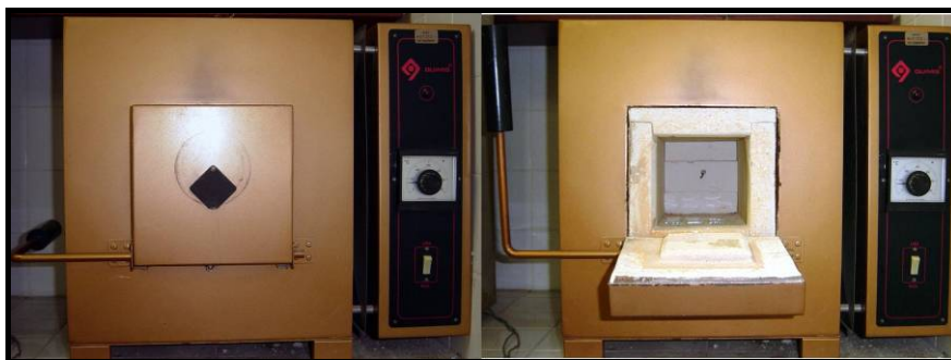
Figura 3.14: Mufla usada para aquecer as lâminas a temperatura de 550°C
