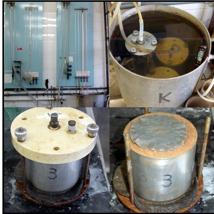
Figura 3.15: Ensaio de Permeabilidade
