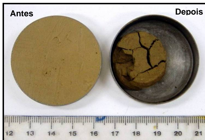
Figura 4.5: Foto ilustrativa da contração da bentonita quando submetida a 110°C.
