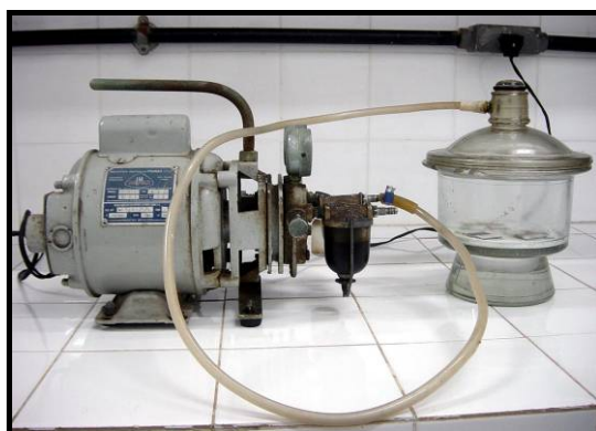
Figura 3.13: Conjunto contendo uma bomba a vácuo e um dessecador com fundo preenchido por etilenoglicol
