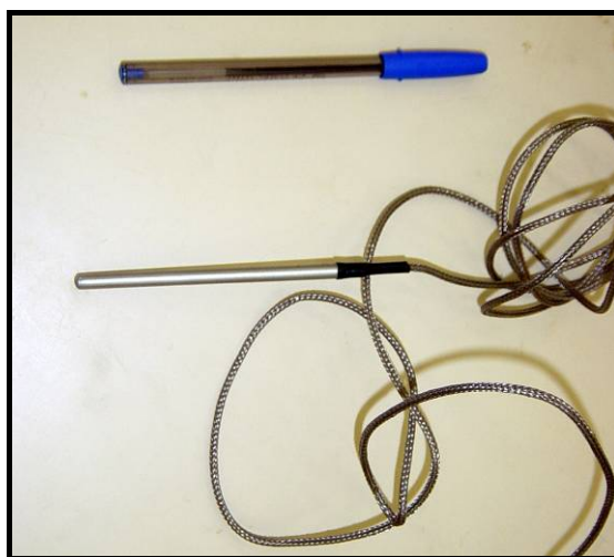
Figura.3.18: Transdutor de temperatura
