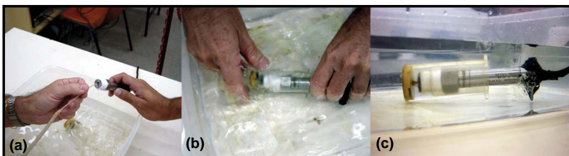
Figura 3.25: (a) Saturação interna do transdutor; (b) Rosqueamento do transdutor no copo de acrílico; (c) Transdutor submerso em água
