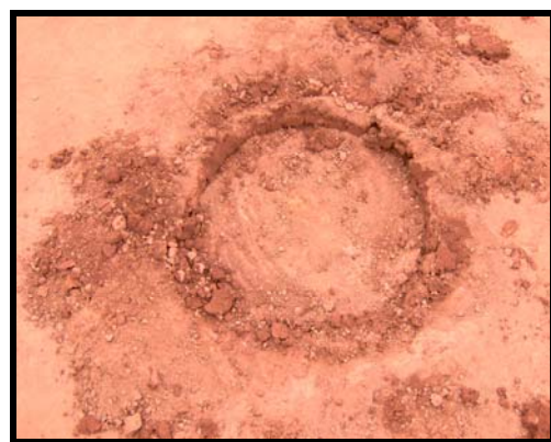
Figuras 3.24 e 3.25: Escavação superficial para montagem do ensaio.
