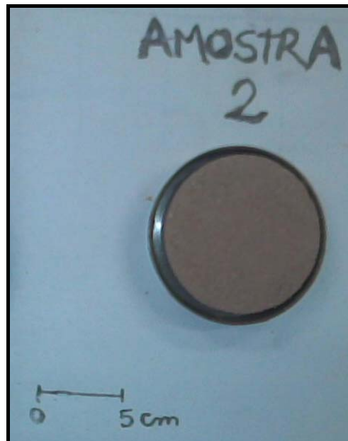
Figura 3.18: Ensaio de contração do solo de P2.
