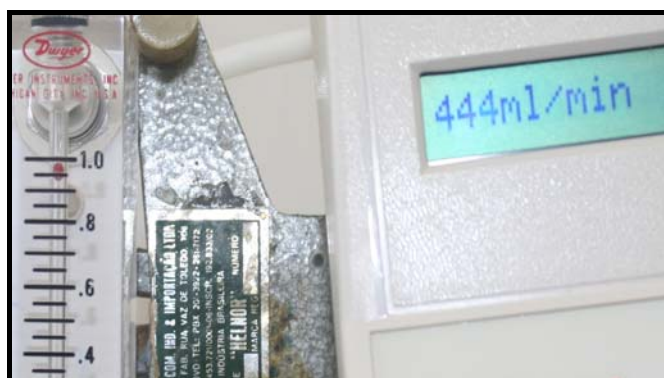
Figura 3.29: Calibração entre equipamentos de leitura.
