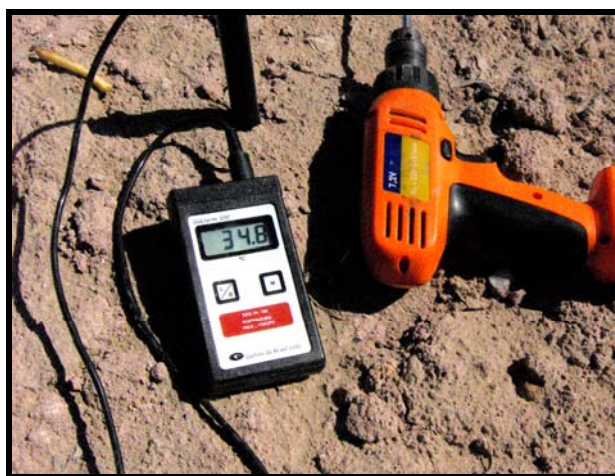
Figura 3.27: Termômetro e furadeira com broca de 40 cm de extensão.
