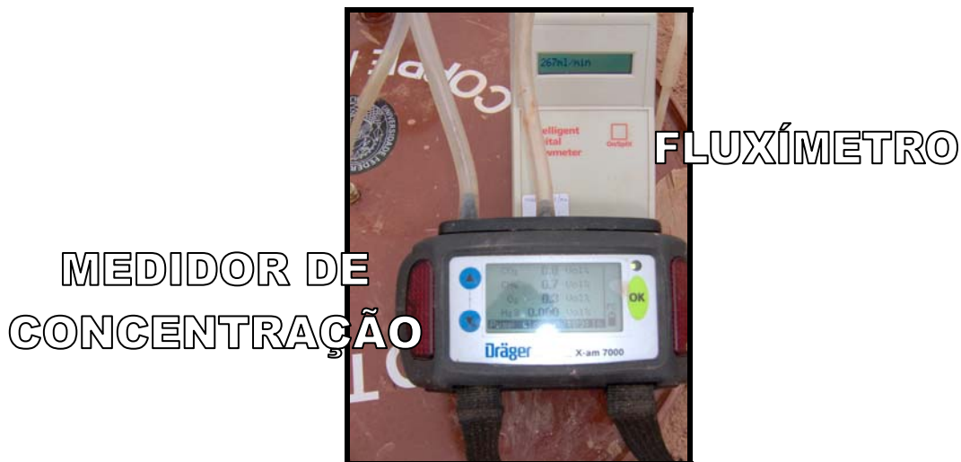
Figura 3.23: Medidor de concentração (primeiro plano) e o medidor de fluxo (segundo plano).
