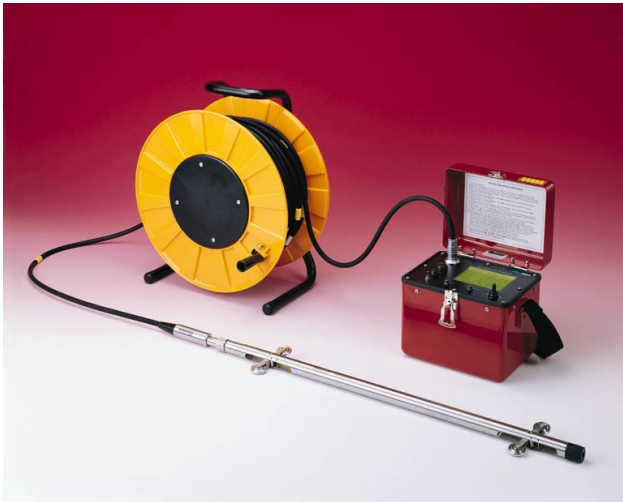
(a) Torpedo, cabo elétrico e unidade de leitura. (b) Tubos de acesso ranhurados.
