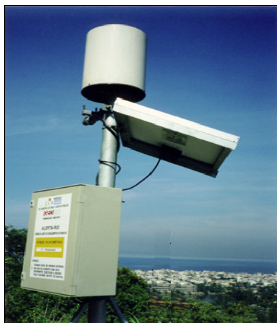
Figura 2.6 – Pluviômetro empregado para monitoramento de chuvas (GEORIO, 2000).
