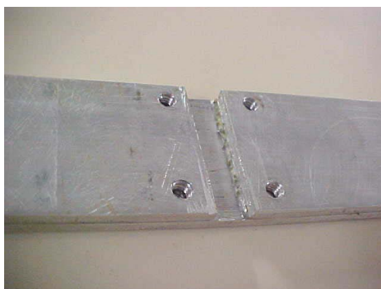
Foto 4-3 – Linha de furos 2 e 3 (vide figura 4-8) rosqueadas para travamento da camada de restrição.
