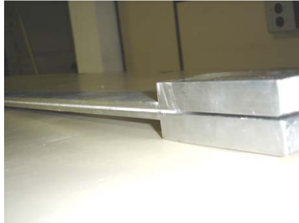
Foto 3-4 – Etapa final - viga sanduíche confeccionada.
