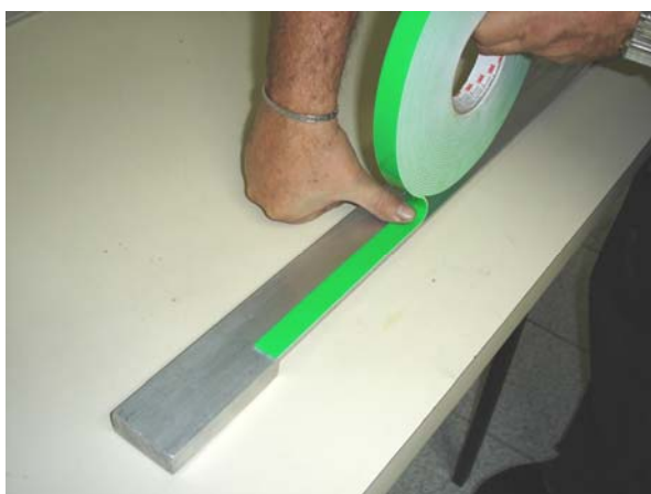
Foto 3-2 – Primeira etapa - Aplicação da camada de material viscoelástico.
