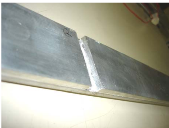
Foto 4-2 – Viga sanduíche sem base de engaste e sem continuidade na camada de restrição.
