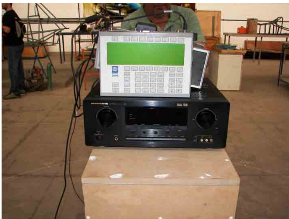
Figura 5.5 – Receiver e RTA posicionados em cima da caixa dipolar.
