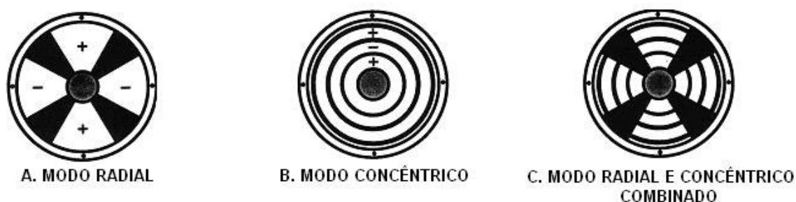
Figura 2.9 – Modos de vibração do cone.
