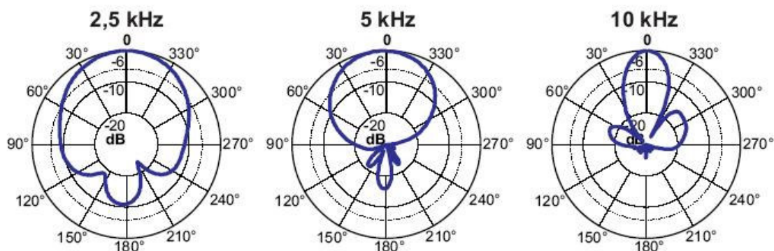
Figura 2.15 – Curva de resposta polar de um tweeter a 2,5 KHz, 5 KHz e 10 KHz.
