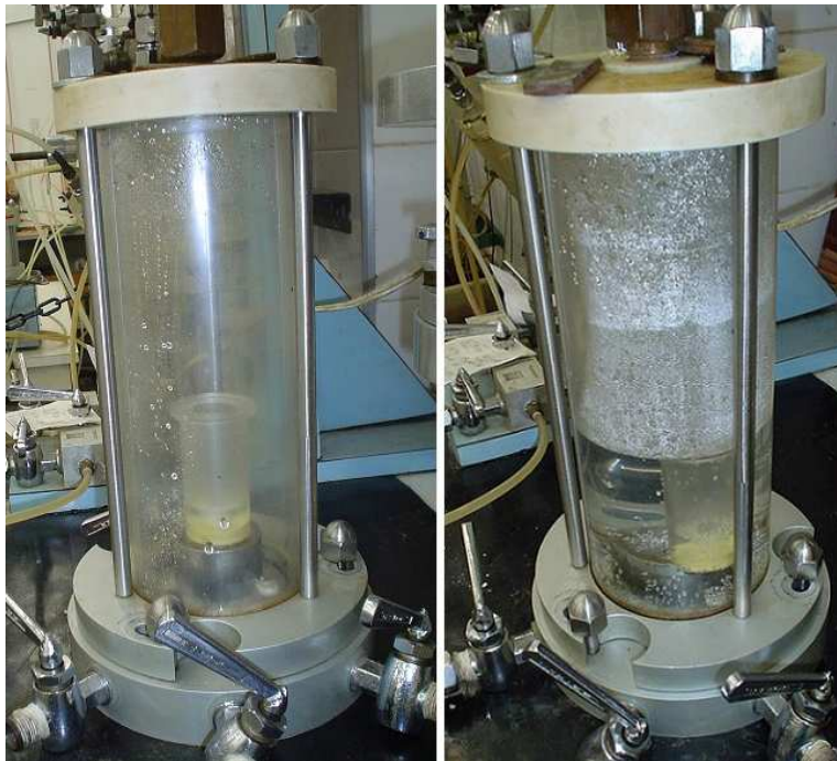
Figura 35: (a) Conjunto no vácuo e (b) depois submerso
