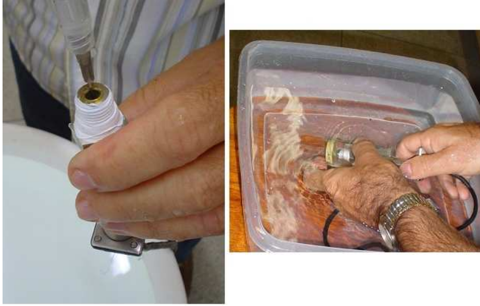
Figura 36: (a) Saturação do reservatório do transdutor e (b) acoplagem do transdutor ao copo de acrílico
