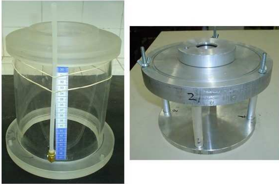
Figura 29: (a)Copo em acrílico e (b)base metálica
