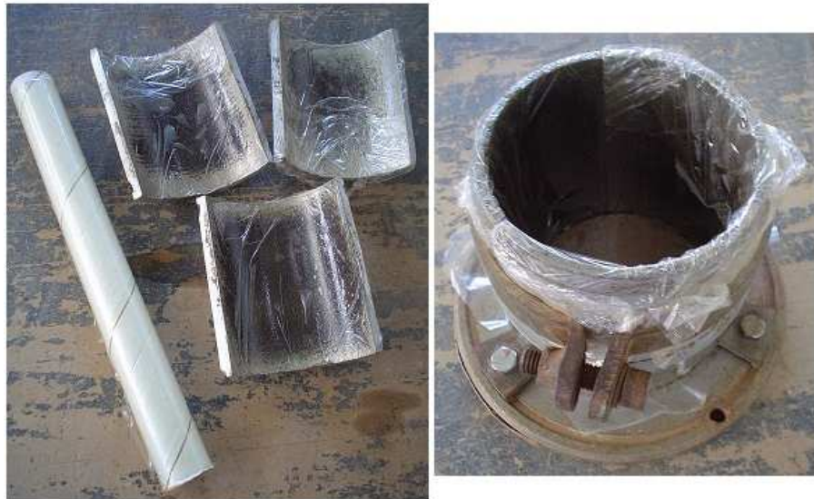
Figura 37: Montagem tri-partido – tamanho Proctor
