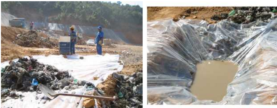
Figura 23: Determinação do peso específico dos resíduos pelo método da cava – Fonte: Silveira (2004)
