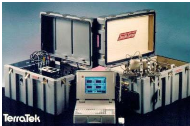
Figura 2.15. Sistema completo de teste ASR (TERRATEK, 1995).
