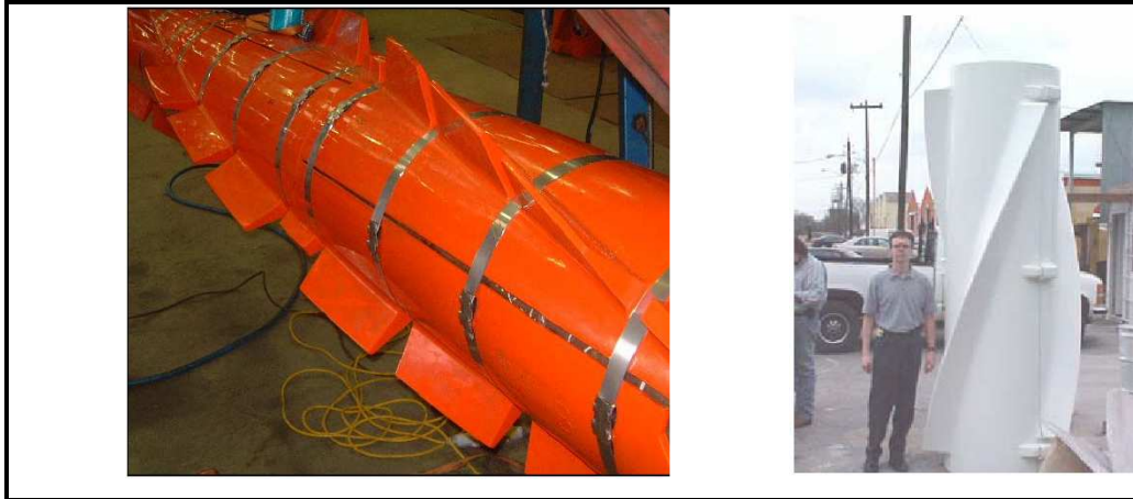
Figura 2.19 – Exemplos de Supressores Helicoidais [1], [39].
