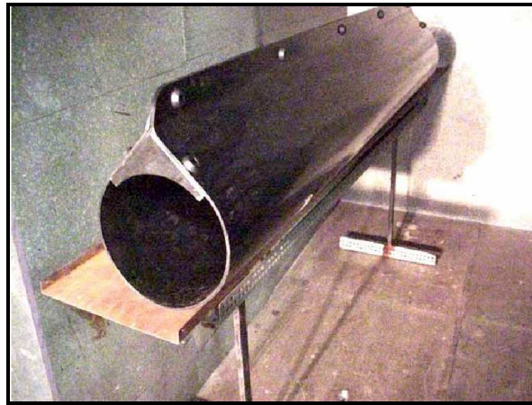
Figura 2.20 – Supressor tipo aerofólio [1], [2].
