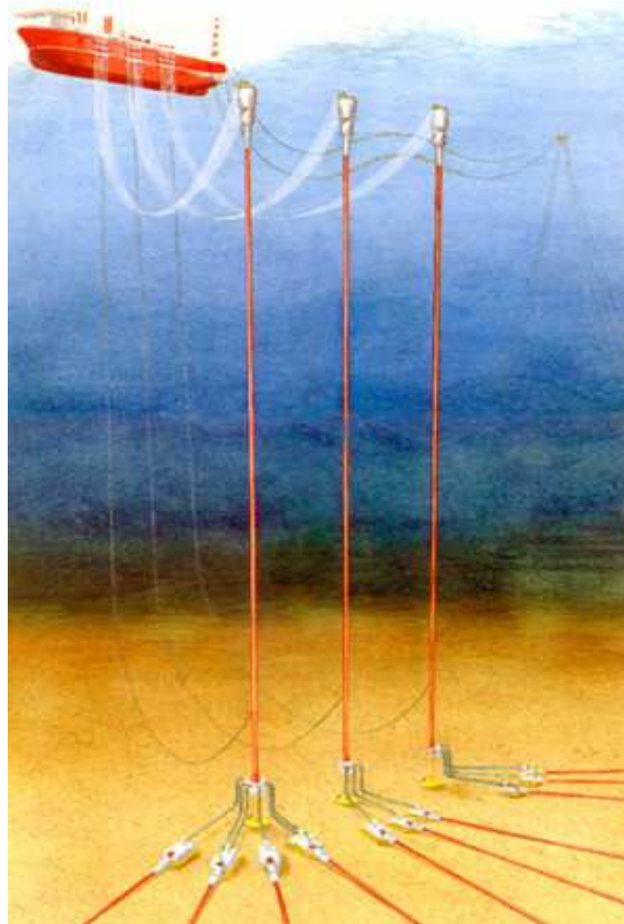
Figura 3.9 – Riser híbrido (Campo de girassol – Angola).
