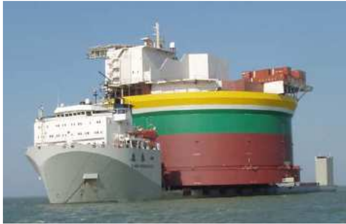
Figura 1.7 – SSP PIRANEMA sendo transportada.
