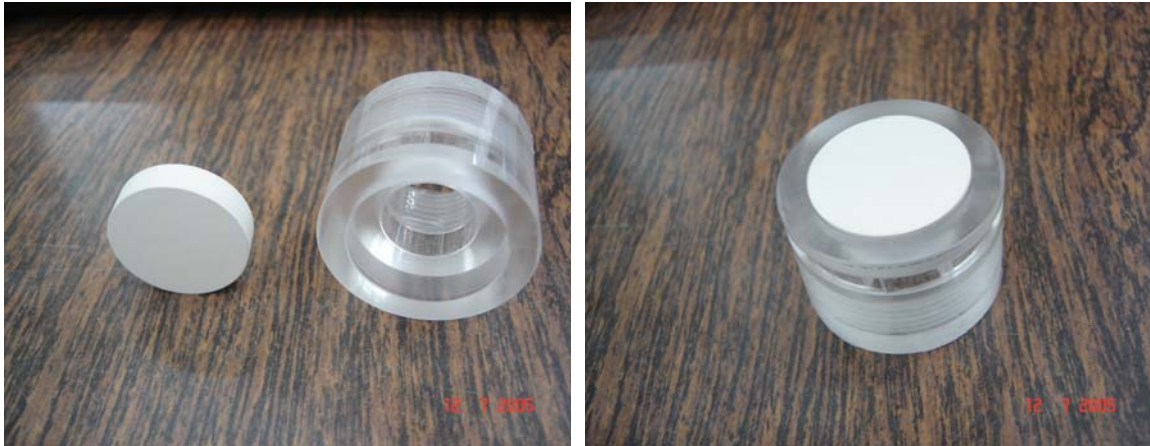
Figura 4.16 – Pedra porosa de 15 bar e copo acrílico
