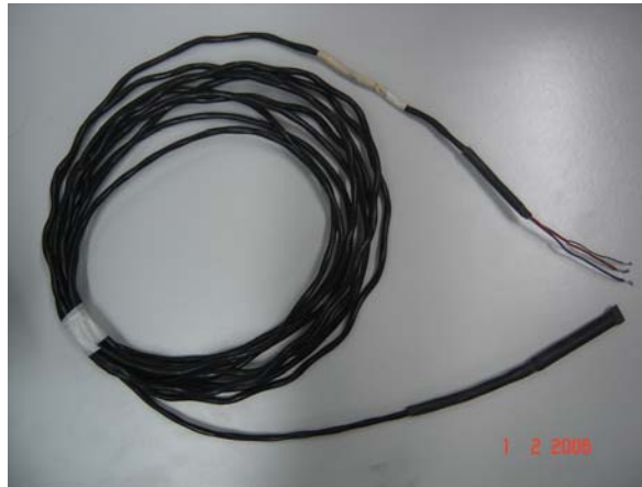
Figura 4.1 – Geotermômetro automatizado – TMP (UP – GmbH, de, 2000)
