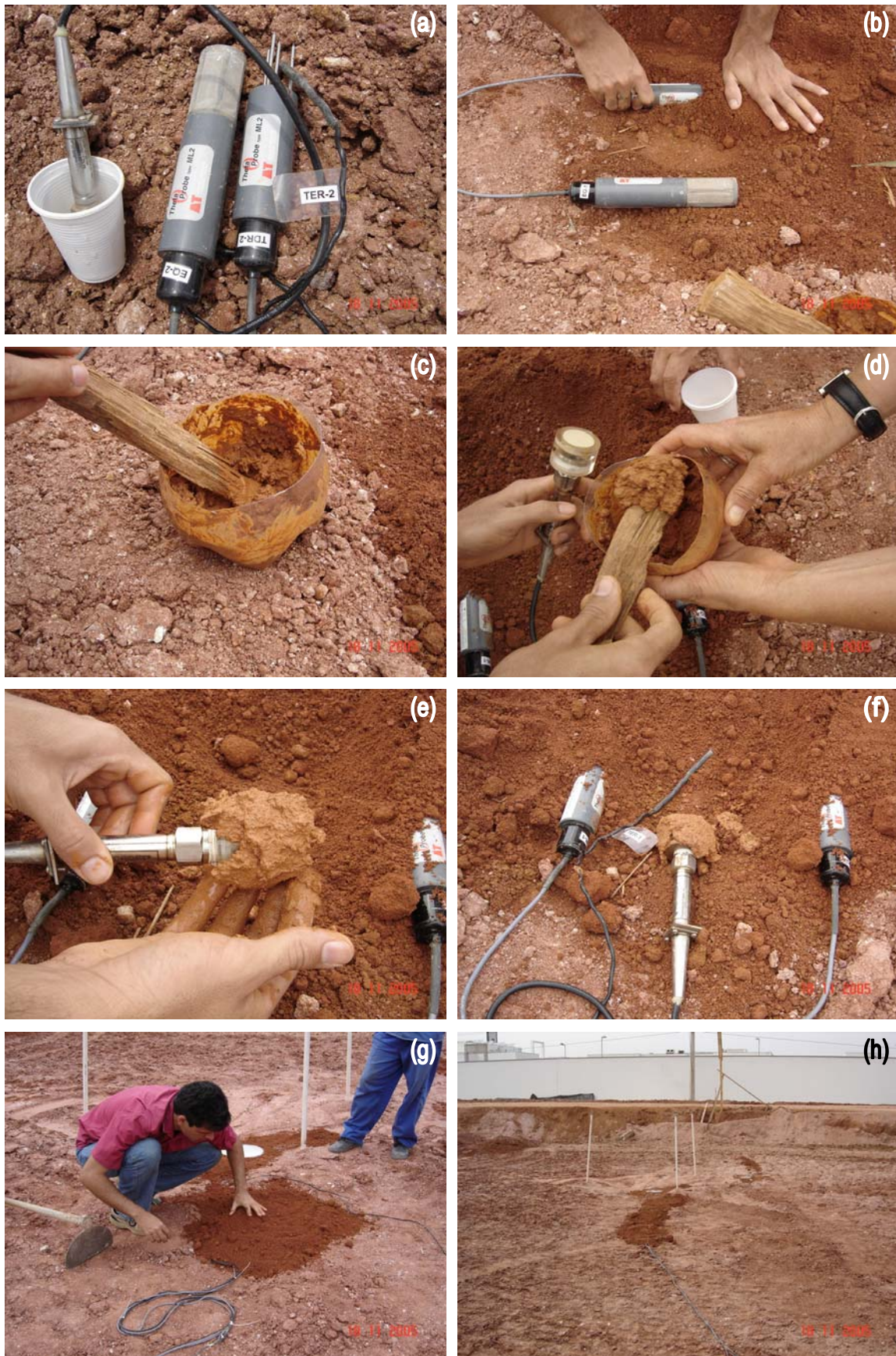
Figura 4.30 – Procedimento de instalação da instrumentação
