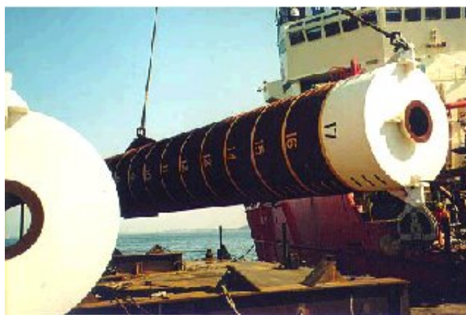
Figura 2.9. Estacas de sucção para ancoragem de risers.
