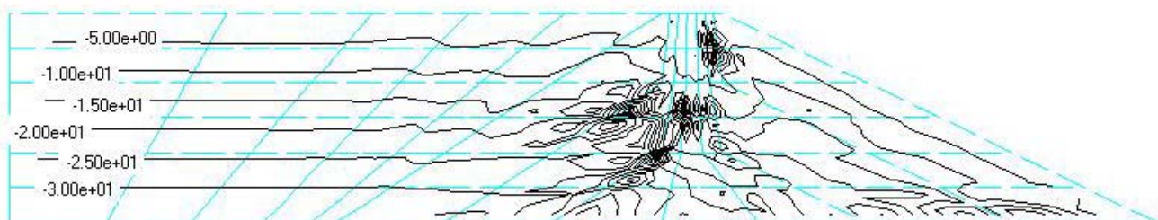
Figura 4.28: Contornos de tensão vertical efetiva – 3º Estágio de modelagem, sem água
