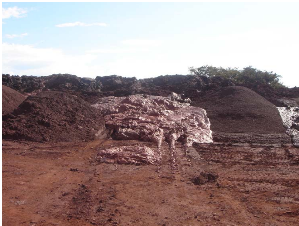
Figura 2.1: Rejeito em pasta, disposto por caminhão
