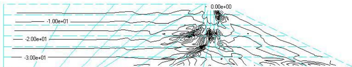
Figura 4.26: Contornos de tensão vertical – barragem alteada por linha de centro com (a) altura total de 36m (3º estágio, H=18m) e com (b) altura total de 18m (3º estágio, H=18m)
