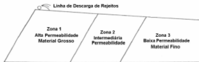
Figura 2.7: Modelo teórico de variação da condutividade hidráulica em depósito de rejeitos (VICK, 1983)
