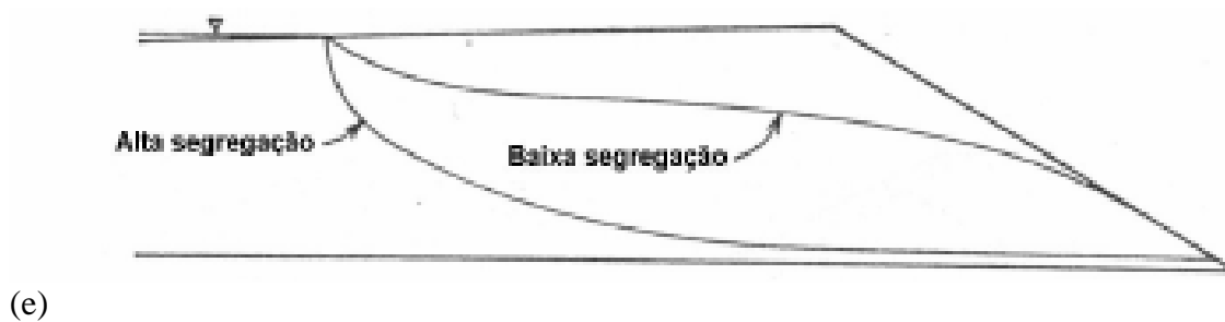
Figura 4.6: (a) geometria da linha freática – k_{\text{under}} = 100 \times k_{\text{over}} ; (b) geometria da linha freática – k_{\text{under}} = 10 \times k_{\text{over}} ; (c) geometria da linha freática – k_{\text{under}} = k_{\text{over}} ; (d) sobreposição das linhas freáticas; (e) variação da superfície freática – VICK (1983)
