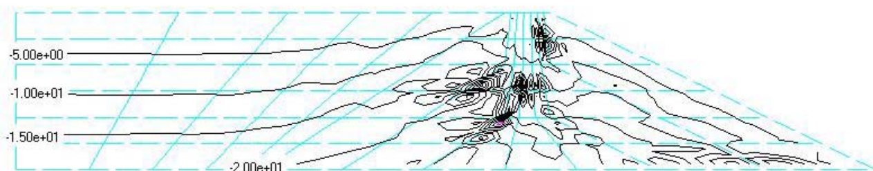
Figura 4.29: Contornos de tensão vertical efetiva – 4º Estágio de modelagem, com água
