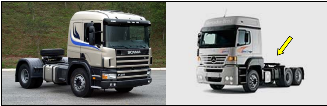
Figura II.1 Cavalos mecânicos ( www.scania.com.br , www.mercedes-benz.com.br ), com a quinta roda indicada pela seta
