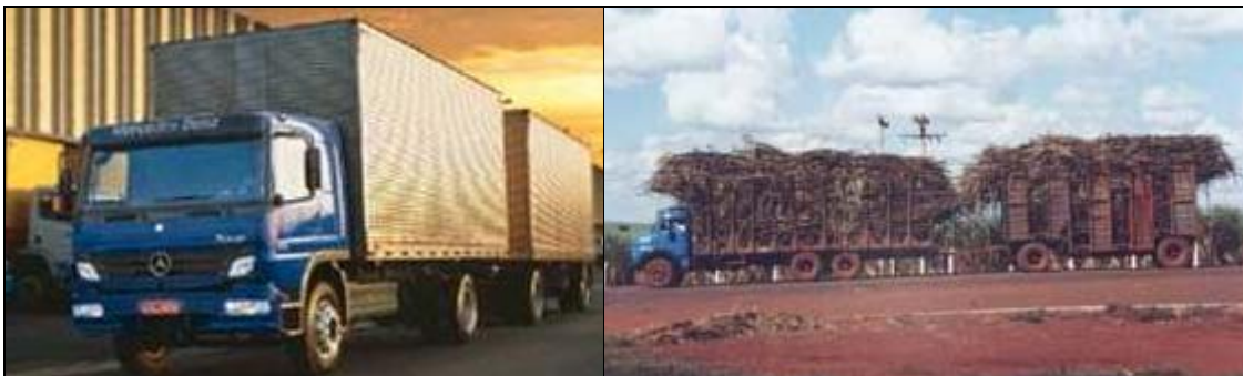
Figura II.3 Caminhões rígidos rebocando carretas (veículos tipo reboque) ( www.mercedes-benz.com.br , WIDMER, 2002)
