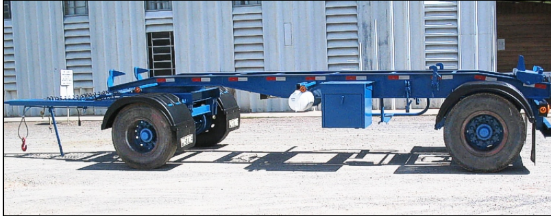
Figura A.1 Encaixe da carreta num dolly de um eixo, para torná-la rebocável, alterando o tipo de engate ( www.pastre.com.br )
