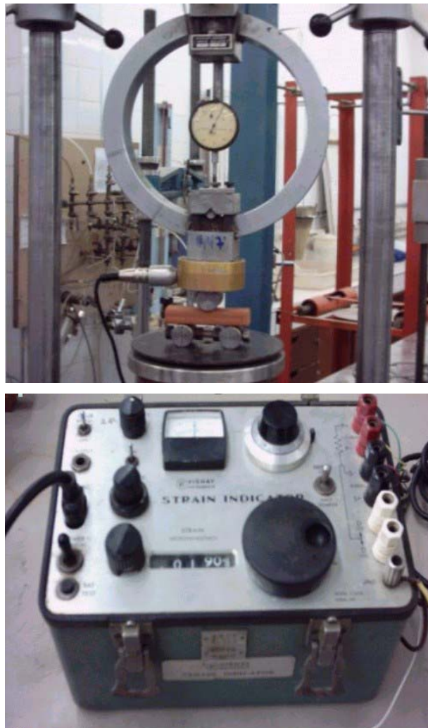
Figura 5.18 Adaptação numa prensa Wykenham e o sistema de aquisição de dados usado na determinação do módulo de ruptura dos corpos-de-prova deste estudo.
