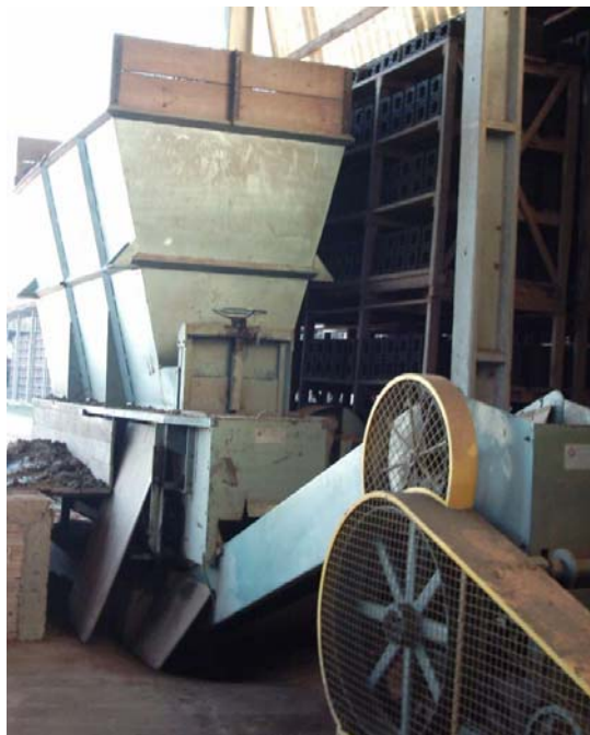
Figura 3.11 – Caixa dosador - Foto do autor (Curitiba – PR em junho de 2004).
