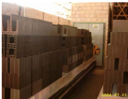
d) Vagoneta entrando no forno túnel (Curitiba – PR em junho de 2004 )
