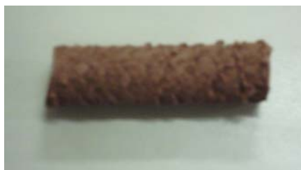
Figura 5.10 – Falha na massa cerâmica oriunda da matéria-prima AM-01 extrudada no equipamento do IME (Foto do autor).
