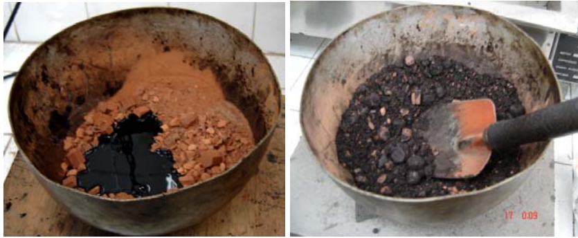
Figura 6.6 –Etapas da mistura do concreto asfáltico desta pesquisa (Foto do autor).
