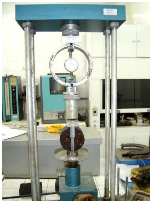
Figura 6.14 – Equipamento usado nesta pesquisa no ensaio de resistência à tração indireta (RT) (Foto do autor).
