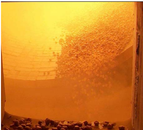
b) Calcinação dos agregados a 1200 °C
