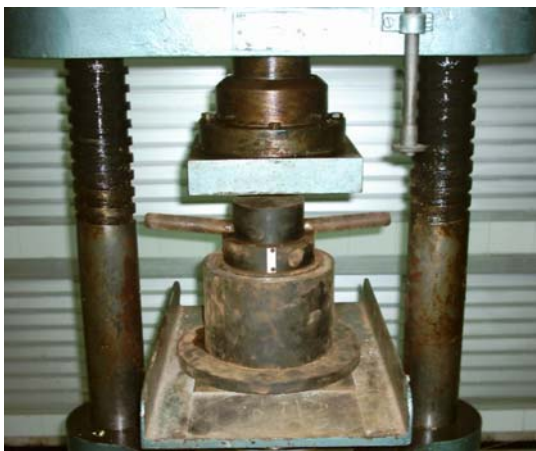
Figura 5.7 – Prensa Amsler do IME e o aparelho de abrasão Los Angeles da COPPE: Equipamentos usados nesse estudo para a britagem dos agregados (Fotos do autor).
