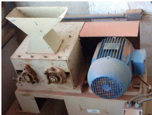
Figura 5.1 - Laminador da UENF: Fabricante VERDES, Modelo 060, Motor de 2CV, Série 0010, RPM 1150 (Foto do autor).
