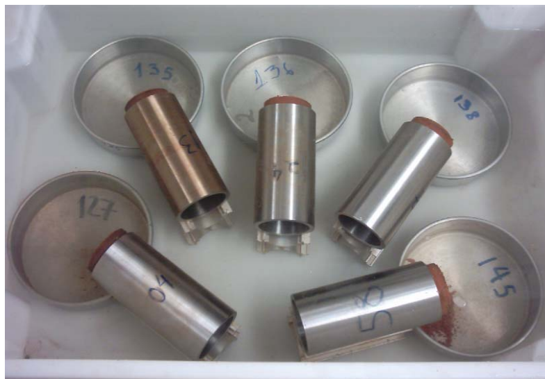
Figura 7.2 Exemplo de arranjo do ensaio de perda de massa por imersão, do solo de comportamento laterítico deste estudo.
