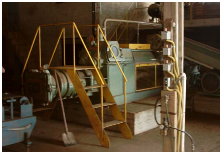
Figura 3.12 – Maromba a vácuo - Foto do autor (Curitiba – PR em junho de 2004).
