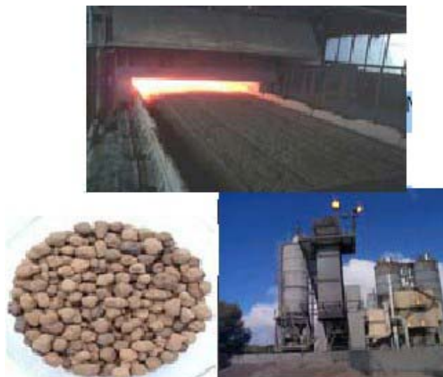
Figura 2.2 Produção do agregado leve Lytag nos Estados Unidos (Lytag, 2004).
