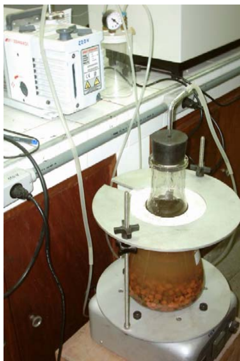
Figura 6.1 – Ilustração do procedimento de saturação dos agregados de argila calcinada através de vácuo, usado neste estudo.
