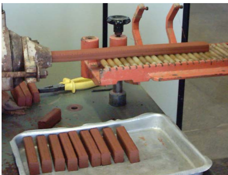
Figura 5.11 – Massa cerâmica oriunda da matéria-prima AM-01 durante a extrusão no equipamento da UENF (Foto do autor).
