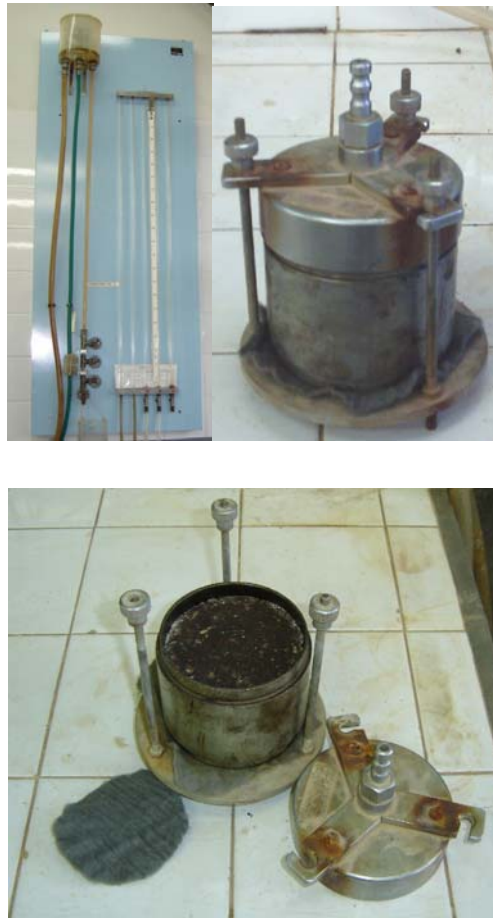
Figura 6.20 – Esquema do ensaio de permeabilidade realizado nesta pesquisa (Fotos do autor).
