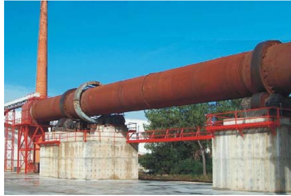
b) Forno rotativo com 60m de comprimento
