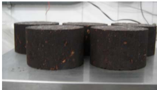
Figura 6.7 – Exemplo de corpos-de-prova moldados com 7,5% de CAP-20 e agregados calcinados nesta pesquisa (Foto do autor).
