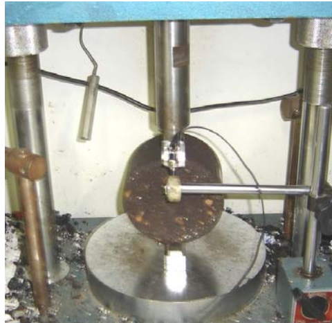
Figura 6.16 – Posicionamento do corpo-de-prova para a realização do ensaio de fadiga (Foto do autor).
