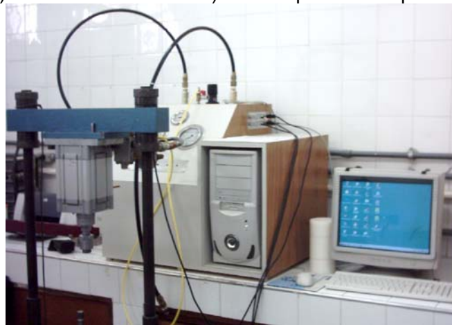
c) Sistema pneumático e sistema de aquisição de dados
