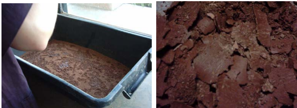
Figura 5.2 - Umedecimento e matéria-prima laminada com teor de umidade próximo do LL/4 (Fotos do autor).
