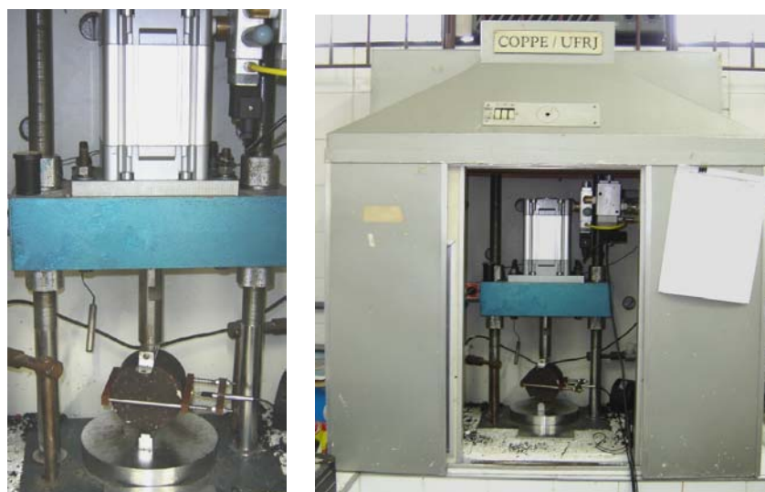
Figura 6.12 - Equipamento usado nesta pesquisa para o ensaio de Módulo de Resiliência (MR) de misturas asfálticas (Foto do autor).
