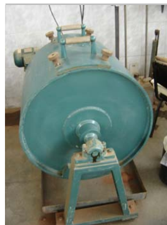
Figura 5.7 – Prensa Amsler do IME e o aparelho de abrasão Los Angeles da COPPE: Equipamentos usados nesse estudo para a britagem dos agregados (Fotos do autor).
