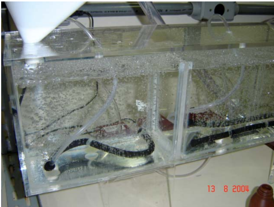
Figura 3.3 – Vista dos aeradores em funcionamento, gerando pequenas bolhas que promovem a agitação do líquido
