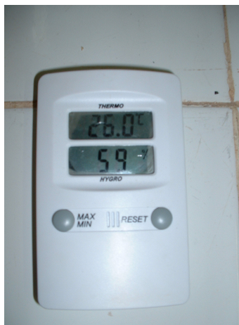
Figura 5-1 – Aparelho utilizado para medir temperatura e umidade relativa do ar máxima e mínima.
