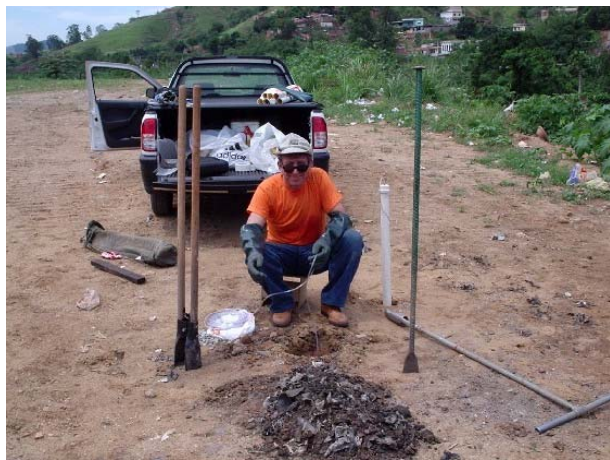
Foto 3 - conjunto de ferramentas para perfuração
