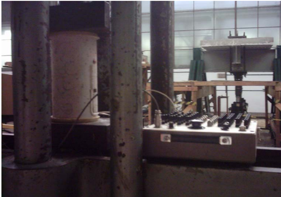
Figura 3.8 - Ensaio de módulo de elasticidade realizado com extensômetro mecânico e extensômetros elétricos.
