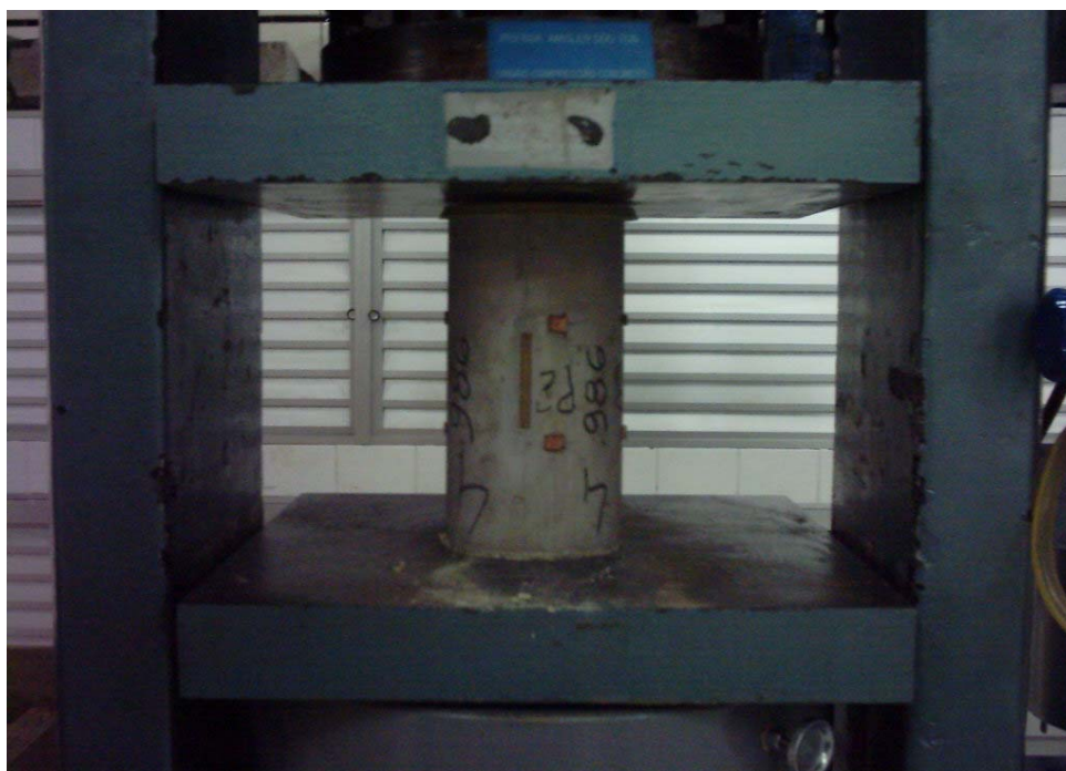
Figura 3.2 - Ensaio de resistência à compressão de concreto, realizado no IME.
