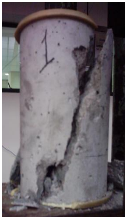
Figura 3.3 - Ruptura de corpo de prova.
