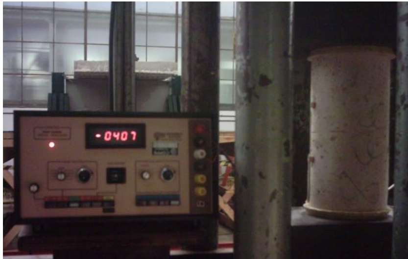
Figura 3.21 - Medição das deformações com extensômetros elétricos de resistência para o traçado da curva tensão-deformação.
