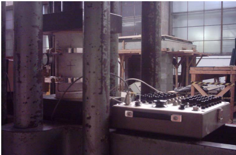
Figura 3.6 - Ensaio de módulo realizado com “compressômetro” e com extensômetros elétricos.
