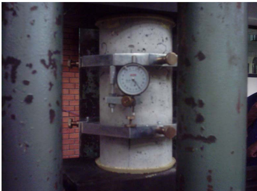
Figura 3.5 - Ensaio de módulo de elasticidade realizado com compressômetro.
