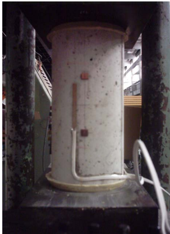
Figura 3.9 - Ensaio de módulo de elasticidade realizado com extensômetro mecânico e extensômetros elétricos.
