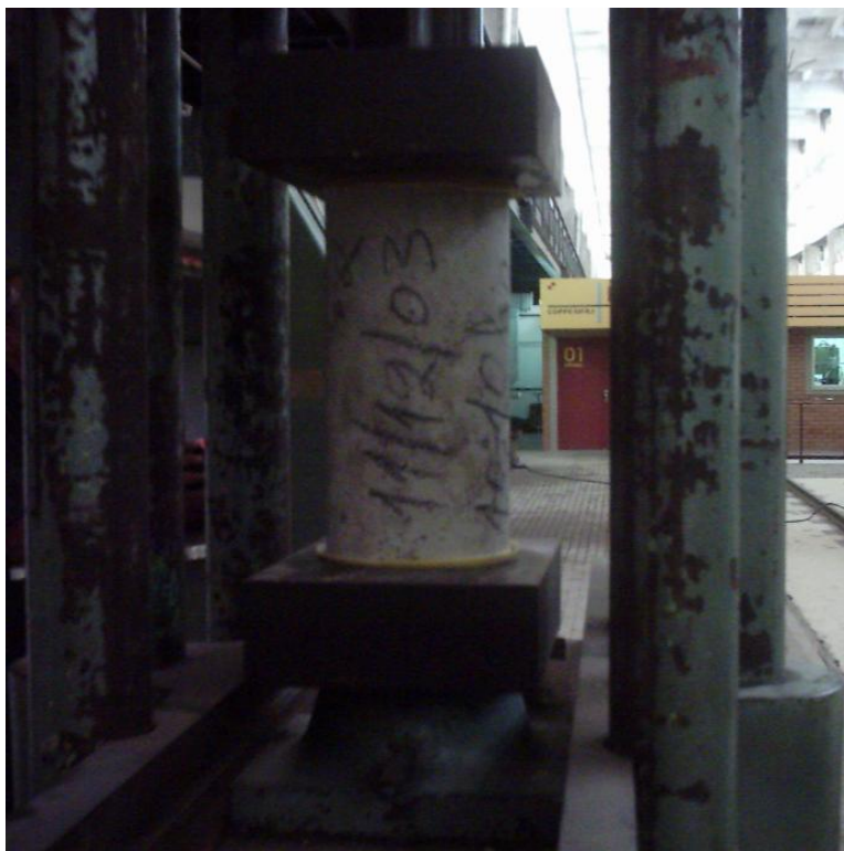
Figura 3.1 - Ensaio de resistência à compressão de concreto, realizado no LABEST.
