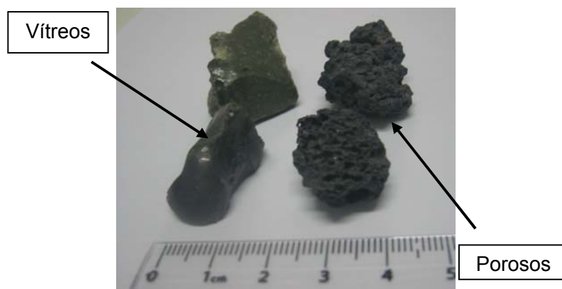
Figura 4.3.5 - Diferenças entre os aspectos da escória utilizada
