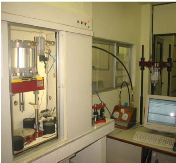
(a) Equipamento CD usado nesta pesquisa (LMP/DET/UFC)
