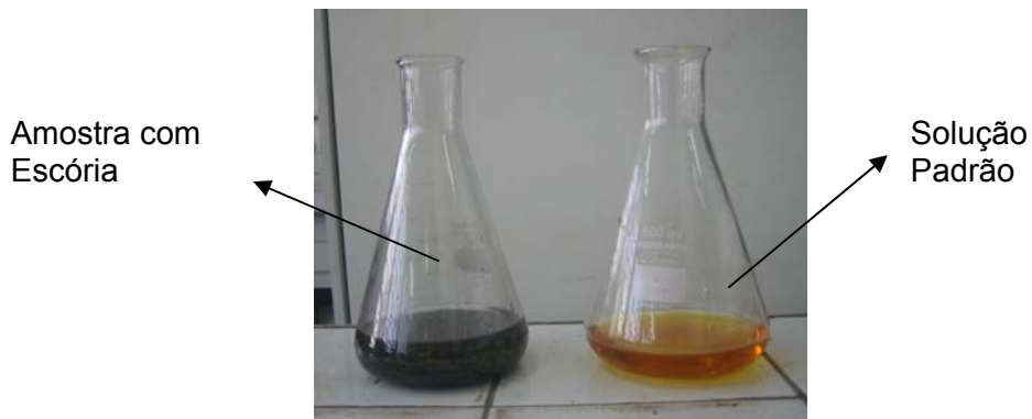
Figura 3.2.6 - Comparação entre as amostras de escória de aciaria e padrão
