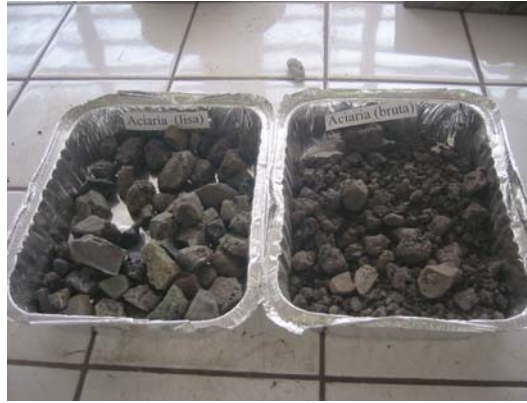
Figura 4.3.11 - Ilustração da separação da escória de aciaria em dois grupos pela aparência dos grãos para compor a mistura 6 (40,0% de escória)
