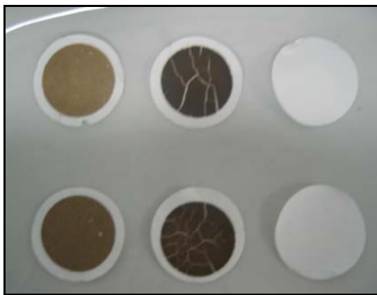
Figura VI.29 - Ilustração com filtros usados nas análises de sólidos suspensos totais do esgoto, do lodo ativado e do permeado, respectivamente.
