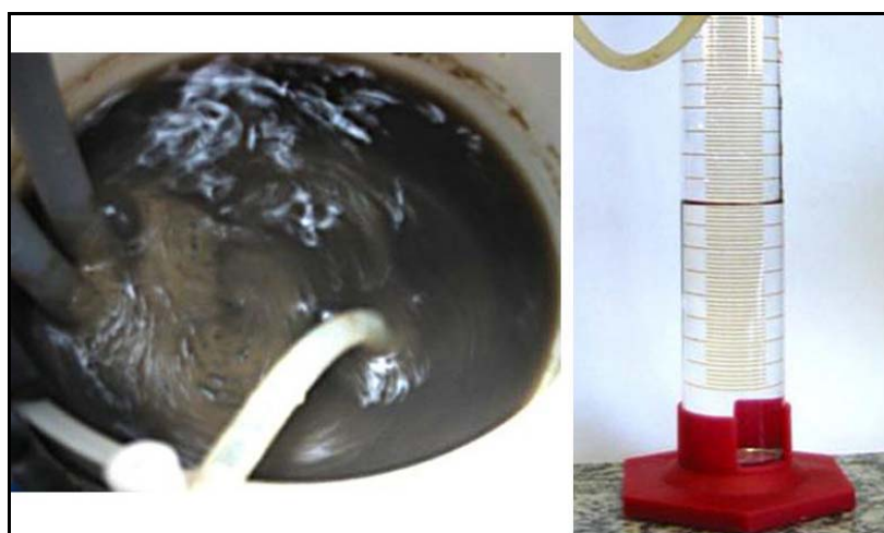
Figura VI.8 - Ilustração do lodo ativado e do permeado.
