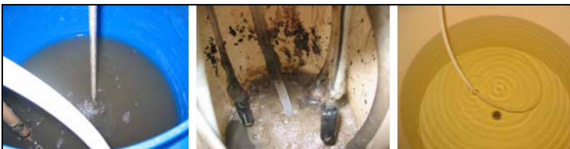
Figura VI.30 – Ilustrações do esgoto bruto, do lodo ativado no tanque de aeração e do permeado, respectivamente.
