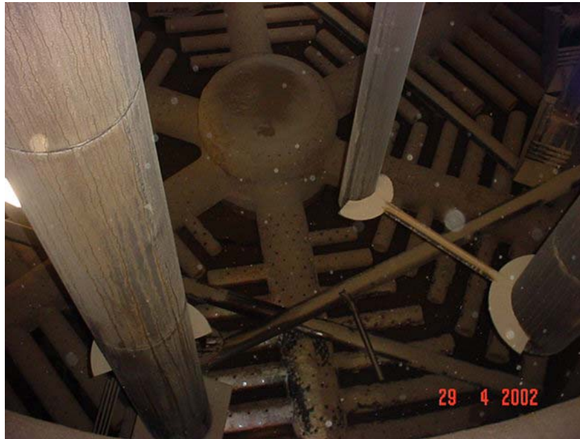
Figura VI.2 – Fundo do regenerador, onde aparecem três pernas caídas sobre o distribuidor de ar do tipo espinha de peixe.
