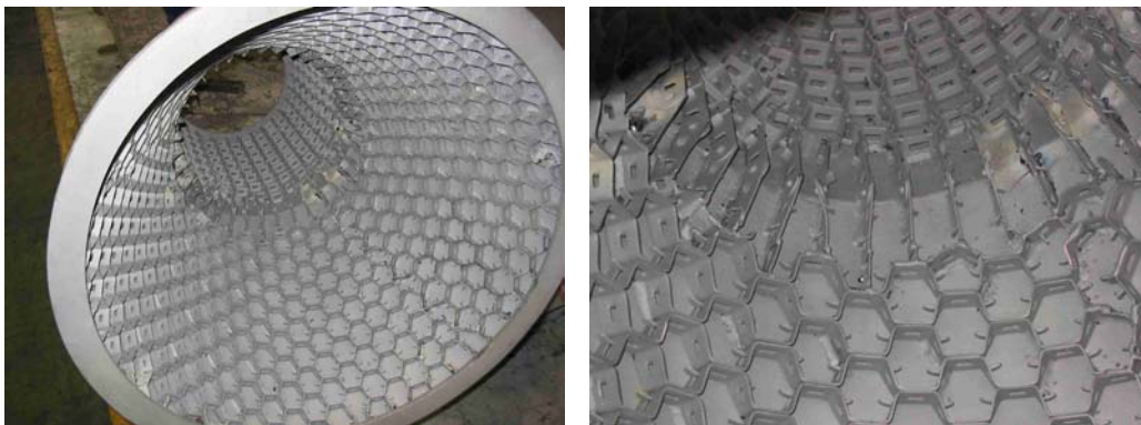
Figura II.8 – Detalhes internos do cone inferior de um ciclone onde aparece a composição mista de chapa de aço inox 304H (espessura 9,5 mm) com o sistema de ancoragem instalado, aguardando a aplicação do refratário.
