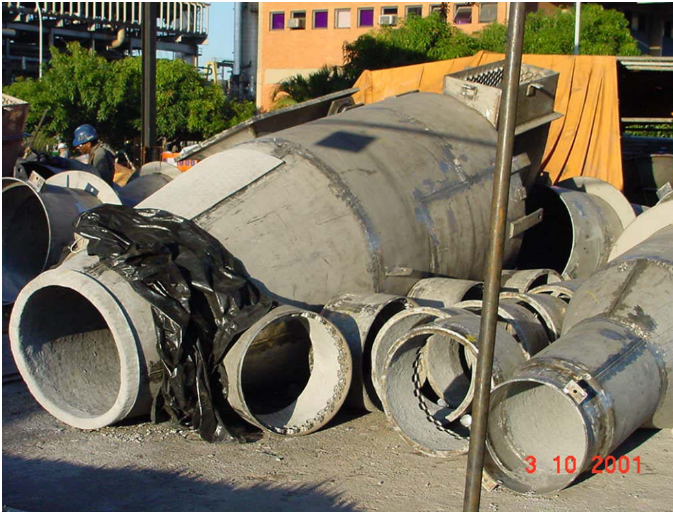
Figura II.7 – Partes de ciclones onde aparece a composição mista de chapa de aço inox 304H com refratário interno aplicado.
