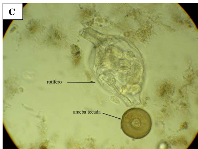
Figura 4.17 – Fotos dos lodos dos reatores contendo 60% de chorume e 40% de esgoto, sendo: (A) chorume ozonizado com 1,5 gO 3 /L; (B) chorume ozonizado com 2,0 gO 3 /L e (C) chorume tratado com Fenton.
