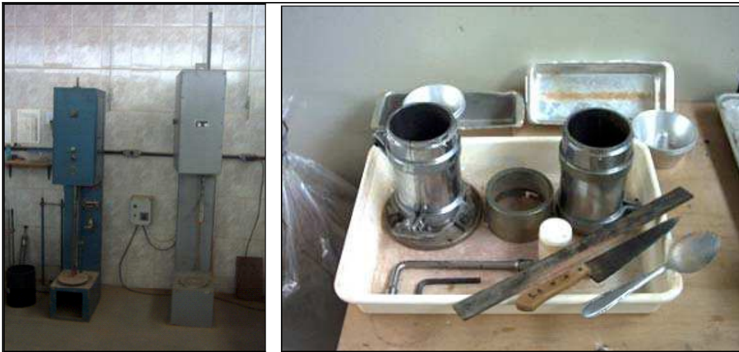
Figura 3.6 - Compactadores mecânicos; moldes de CP, cápsulas e demais utensílios usados no ensaio de compactação.
