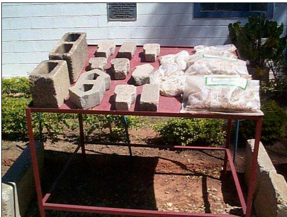
Figura 3.3 - Blocos e intertravados de concreto produzidos com agregados reciclados tipo A produzidos na usina do Estoril (PBH). (Fotos do autor, ago/2003).
