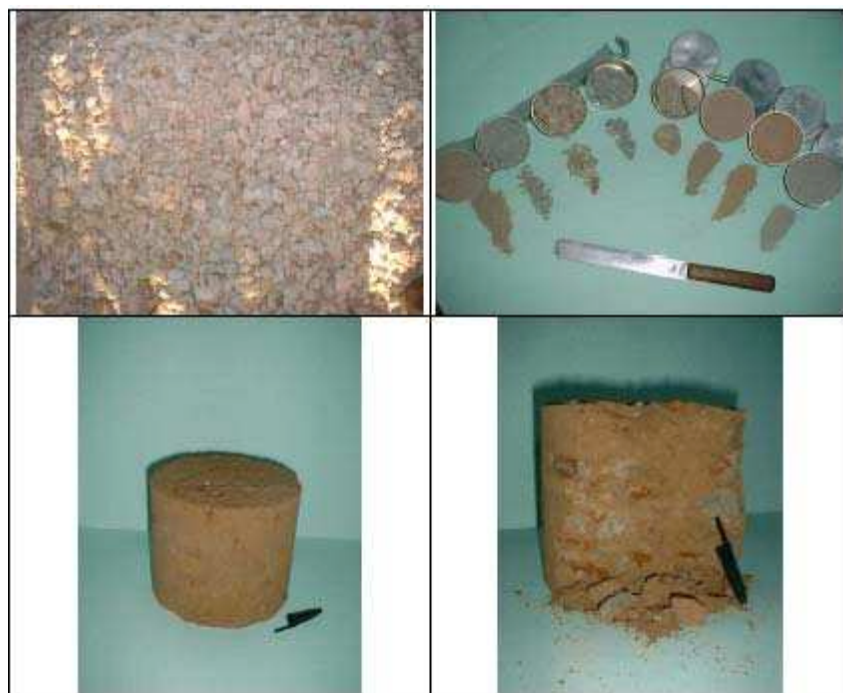
Figura 2.3 – Agregado reciclado de Brasília: vista geral, frações, corpo de prova inteiro e desfeito. (Motta e Fernandes, 2003).
