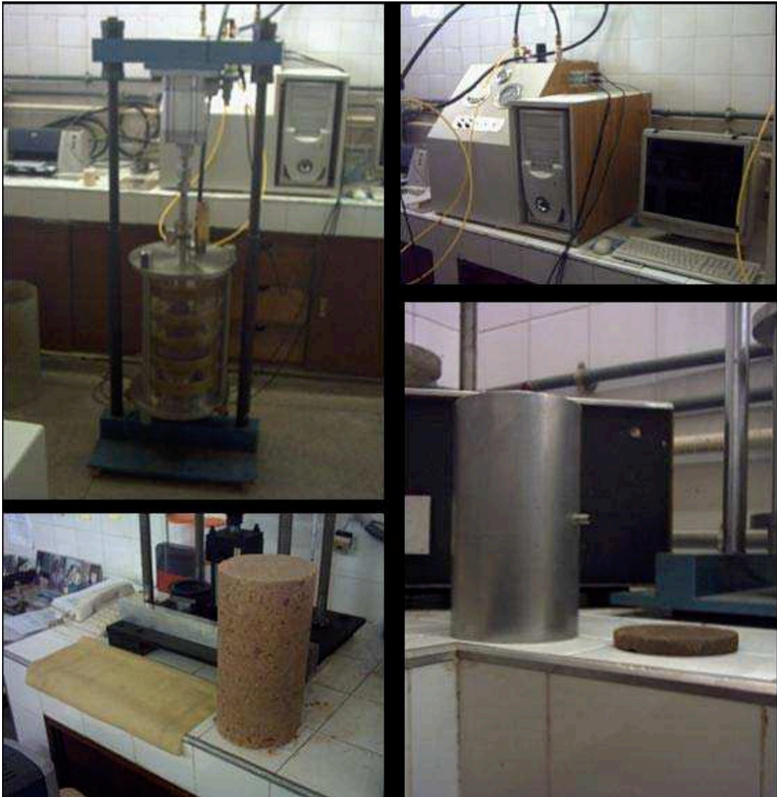
Figura 3.7 – Visão geral do equipamento montado para o ensaio triaxial; equipamento de controle monitoramento de tensões e microcomputador. (Fotos do autor, 2004).
