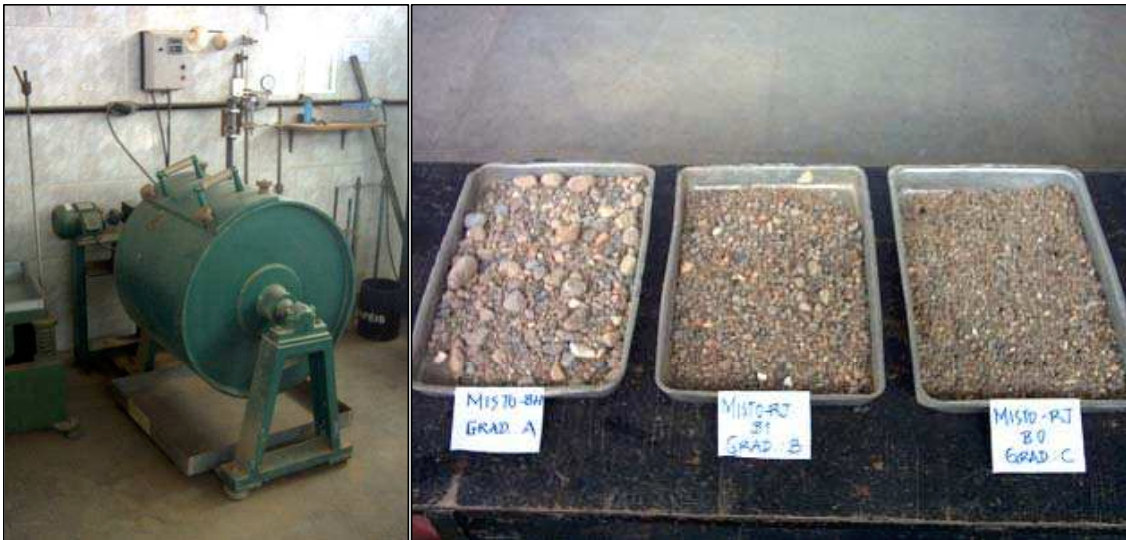
Figura 3.8 - Máquina “Los Angeles”; amostras a serem ensaiadas de Belo Horizonte e do Rio de Janeiro.
