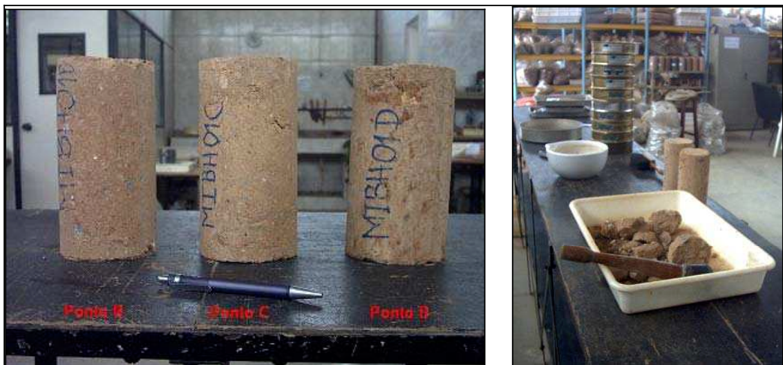
Figura 4.4 – Corpos-de-prova (CPs) de agregados tipo Misto de Belo Horizonte, compactados sob energia intermediária (MIBH01B, MIBH01C e MIBH01D); bancada com estes CPs destinados a novo ensaio de granulometria após processo de destorroamento.
