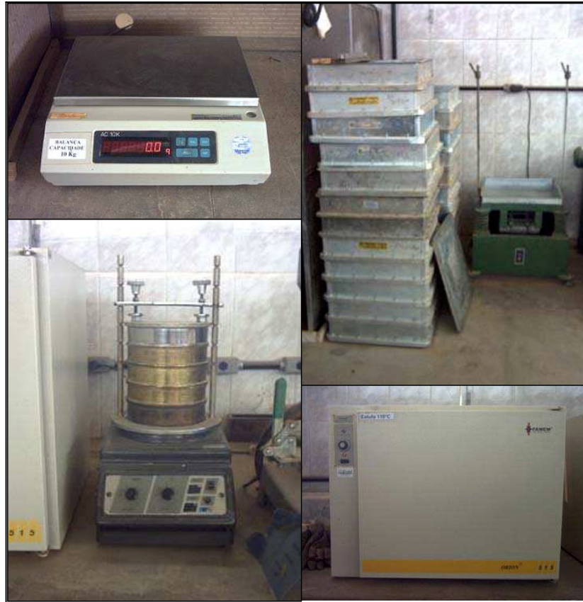
Figura 3.5 - Balança com capacidade de 10 kg, sensível a 0.1 g; peneirador com peneiras quadradas; peneirador com peneiras redondas; estufa. (Fotos do autor, 2004).
