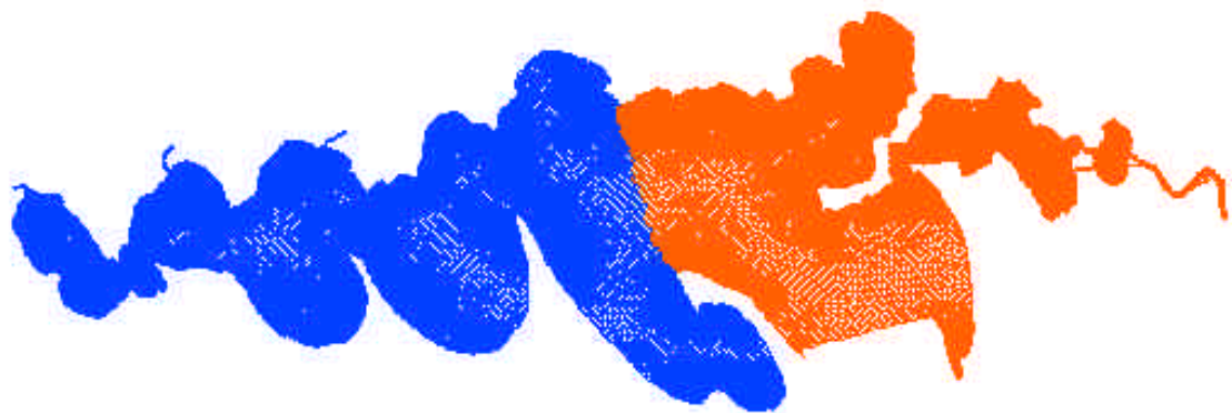
Figura 9. Malha particionada em 2 subdomínios.
