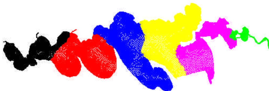
Figura 11. Malha particionada em 6 subdomínios.
