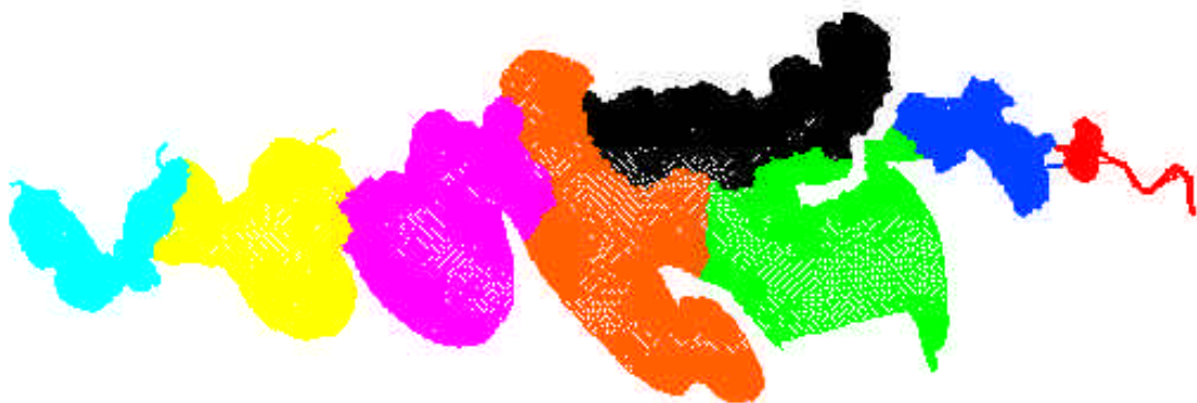
Figura 12. Malha particionada em 8 subdomínios.
