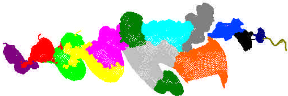
Figura 15. Malha particionada em 14 subdomínios.
