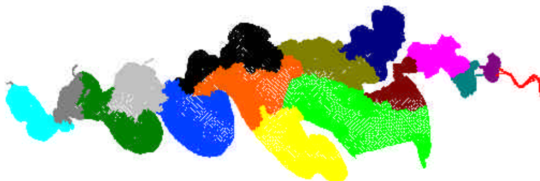
Figura 16. Malha particionada em 16 subdomínios.
