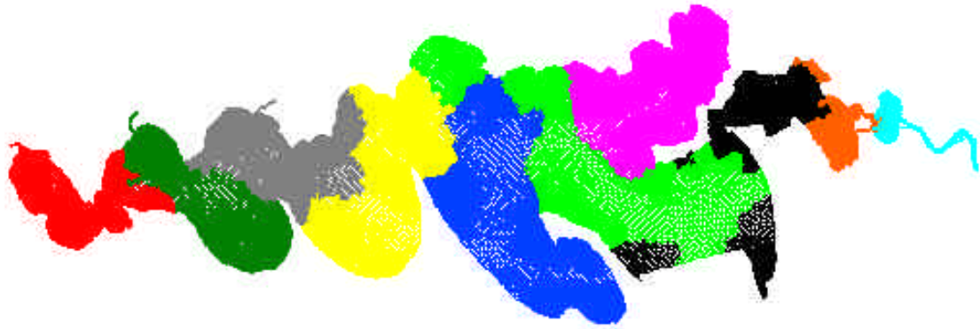
Figura 13. Malha particionada em 10 subdomínios.
