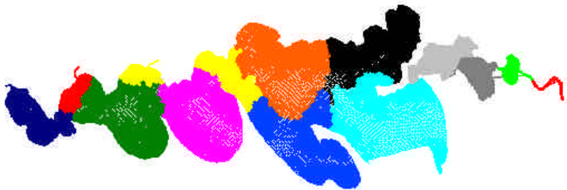
Figura 14. Malha particionada em 12 subdomínios.
