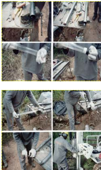
Figura 3.4b - Sequência de montagem do amostrador utilizando a técnica de cravação direta (da esquerda para a direita e de cima para baixo).
