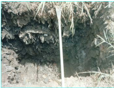
Figura 3.19 - Trincheira aberta no local do furo Q-2 para romper a camada de resíduos
