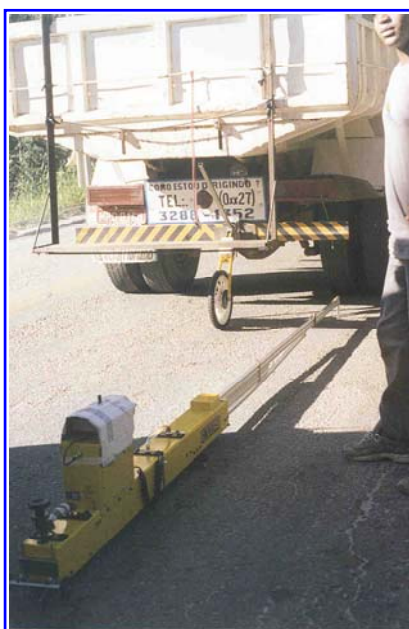
FIGURA 2.2 – Ilustração do Deflectômetro Digital (foto obtida pelo autor durante a realização de ensaios na BR-393/ES (Cachoeiro – Muqui) em março de 2002)
