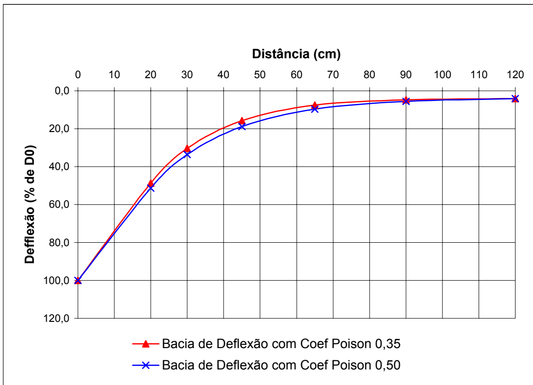
FIGURA 3.11 - Comparação entre a bacia medida no campo e a bacia recalculada pelo ELSYM5 BR-418/MG - Trecho Ataleia-Carlos Chagas - est. 688 - FWD
