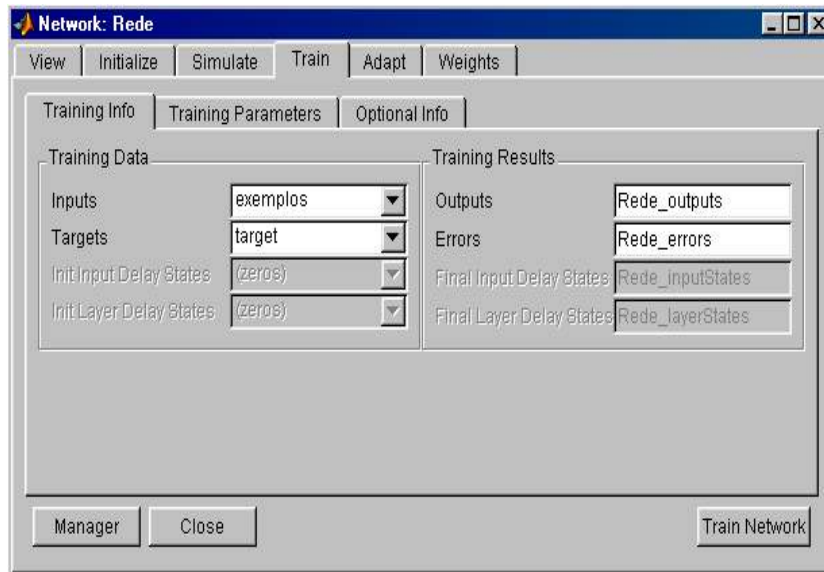
Figura 4.6 – Inserir as entradas e objetivos e posteriormente selecionar-se o ícone Train Network, para treinar a rede
