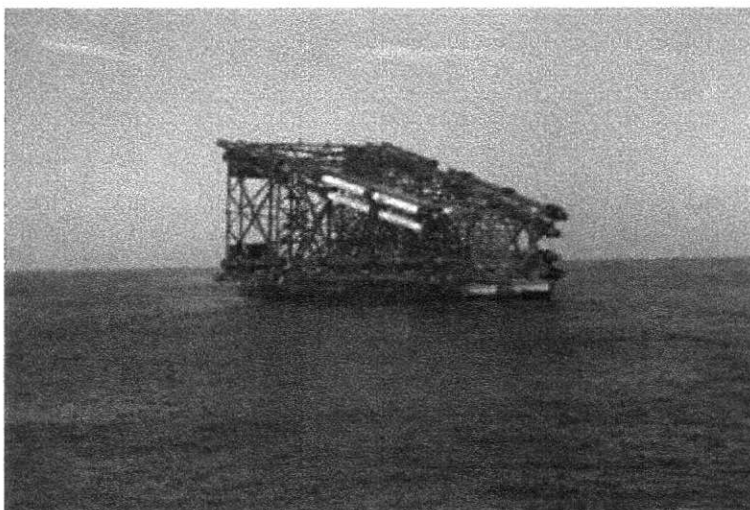
Figura I-3 - Jaqueta sendo transportada sobre o mar
