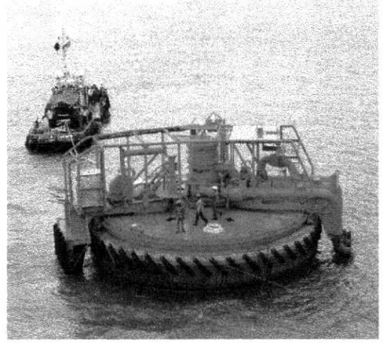
Figura II-16 - Tipos de transportes de uma monobóia
