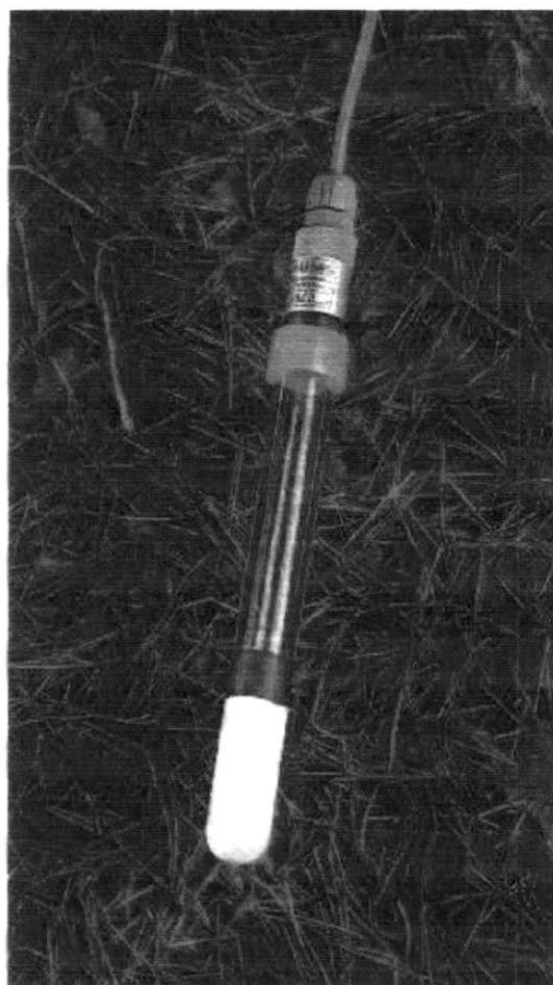
Figura 5.6 Tensiômetro automatizado T4A, desenvolvido na Alemanha (UMS-GmbH, DE, 2000).
