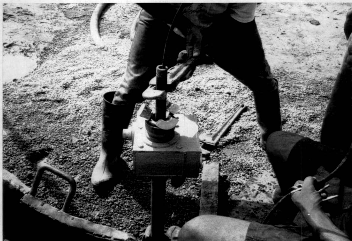
Fig. 3.12 Aplicação das Revoluções para a Realização do Ensaio Amolgado
