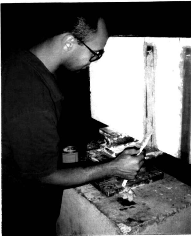
FOTO 15 - Aplicação da camada de resina sobre a chapa para colagem da 2ª camada de estribo
