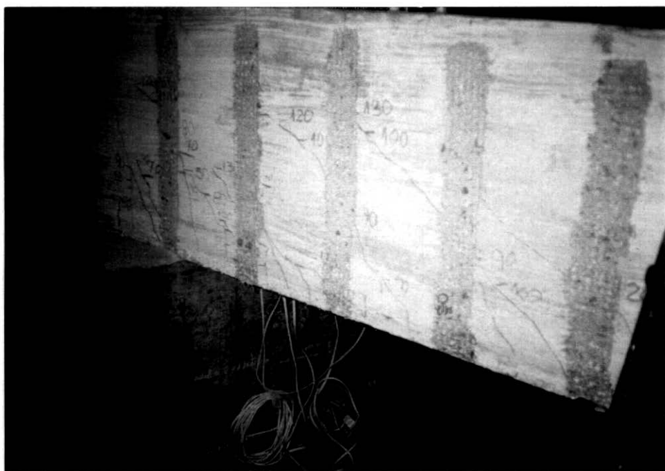
FOTO 4 - Superfície da viga após a preparação
