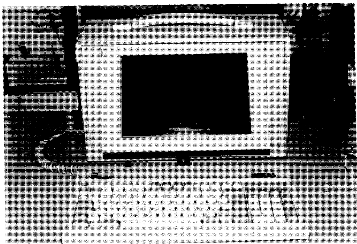
Foto III.7 - Microcomputador portátil, para recepção e armazenamento em disquete das leituras obtidas pelo plotter .
