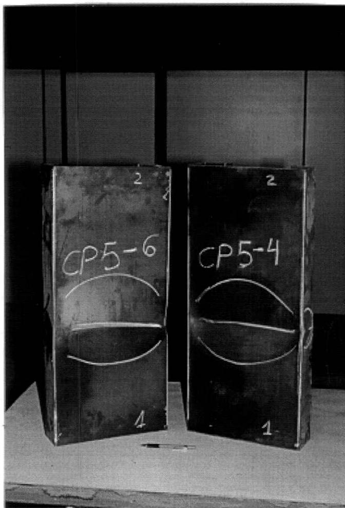
Figura 4.9- Modos de colapso identificados nos ensaios de compressão centrada de colunas curtas de seção esbelta tipo rack. CP5-4 e CP5-6 (Série CP5)
