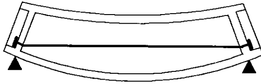
Fig.4.3.- Viga isostática com protensão externa
