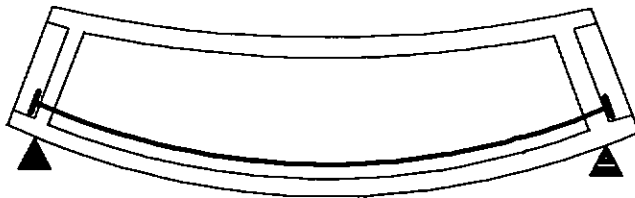
Fig. 4.1.- Viga isostática com cabo interno aderente
