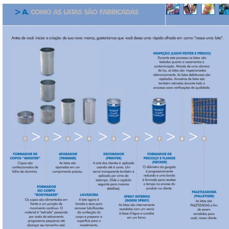
Figura 52 - Descrição da fabricação de latas de alumínio.
