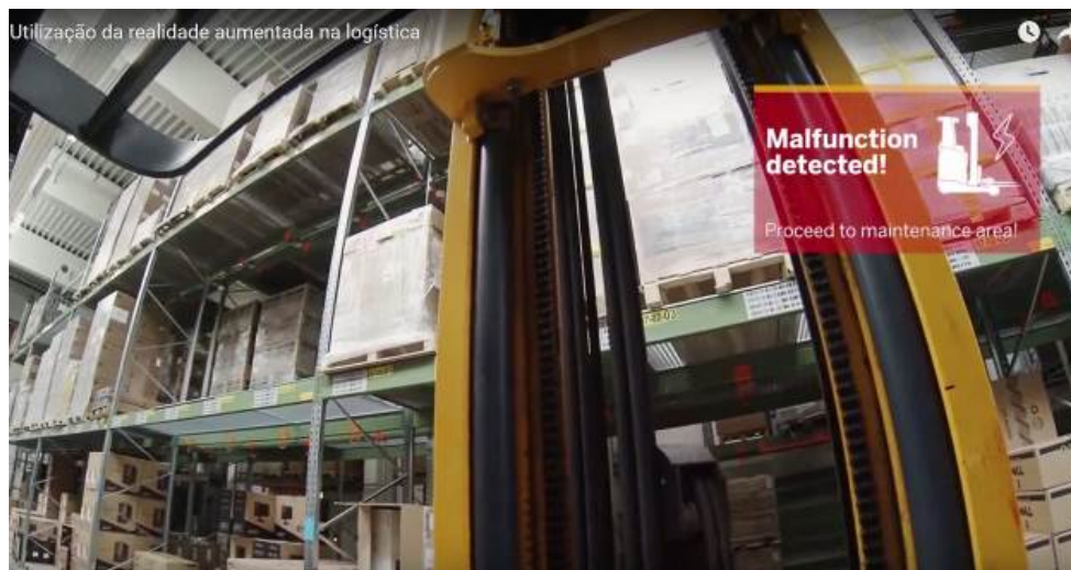
Figura 14 - Detecção de defeitos utilizando a RA.
