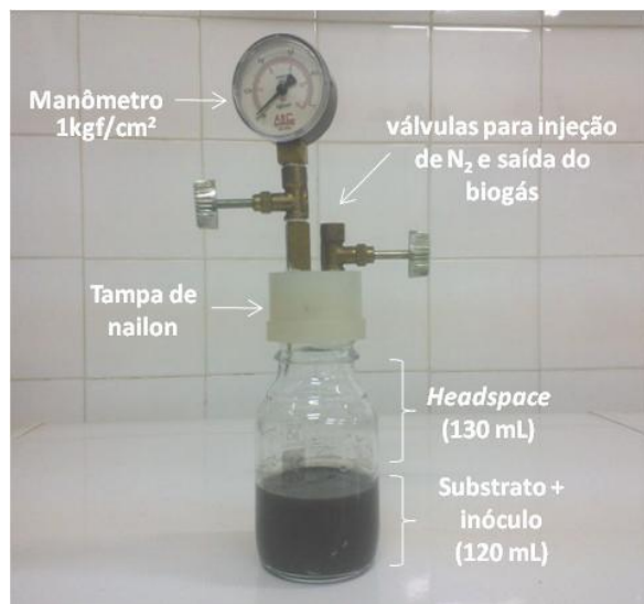
Figura 3.3. Aparato e procedimento experimentais utilizado para a realização dos Ensaios BHP e BMP.
