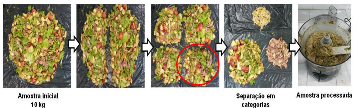
Figura 3.1. Esquema geral das etapas do quarteamento e processamento das amostras de resíduos orgânicos.
