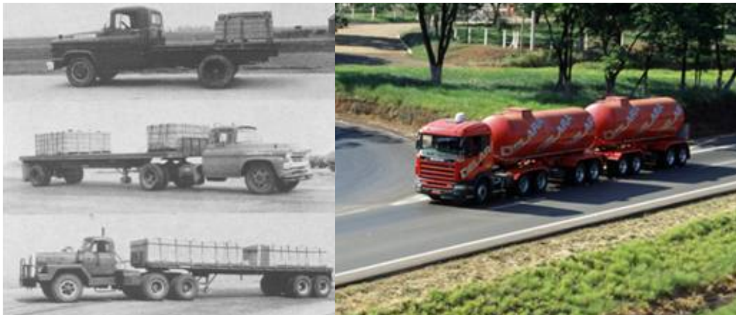
Figura 6.2: Veículos utilizados na pista experimental da AASHTO da década de 50 (esquerda) em comparação com um dos veículos atualmente em operação (direita).
