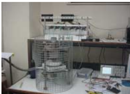
a) Armazenador de Energia ( Flywheel )
