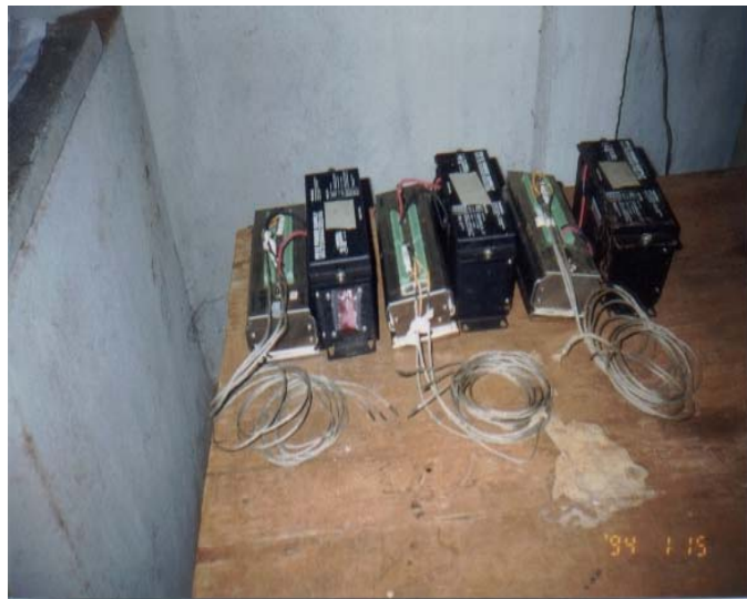
Figura 2.11 – Termopares para a medida da temperatura da superfície.
