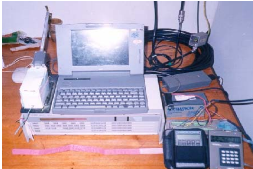
Figura 2.7 – Módulo Digicora de recepção dos dados de radiossondagem.
