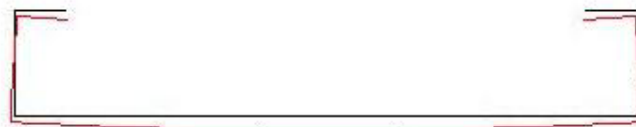
Figura 5.5 Vista da deformada na seção transversal em uma seção a 557mm da extremidade inferior, ampliada em 100.000 vezes, para uma carga de P/P_{cr}=0,02 . Painel 600x100x50, espessura de 1,0 mm, comprimento de 2600 mm.
