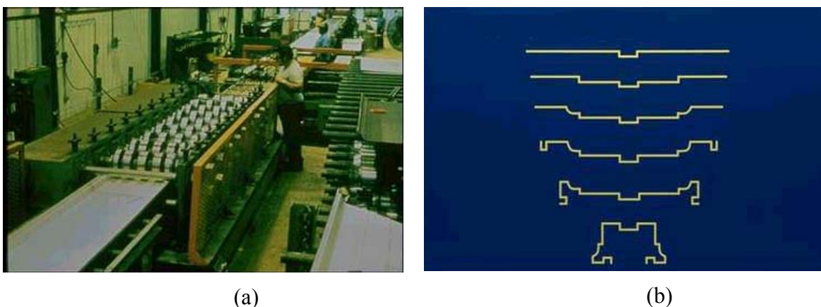
Figura 1.1 (a) perfiladeira de rolete contínua; (b) seqüência de dobras em uma perfiladeira.
