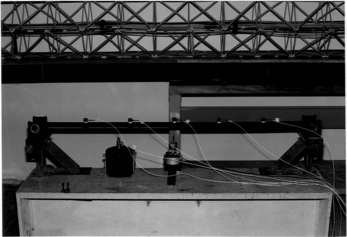
Foto V.1 - Vista geral do ensaio da viga bi-apoiada submetida a excitação dupla, onde podem ser vistos os excitadores, as células de carga e os acelerômetros.
